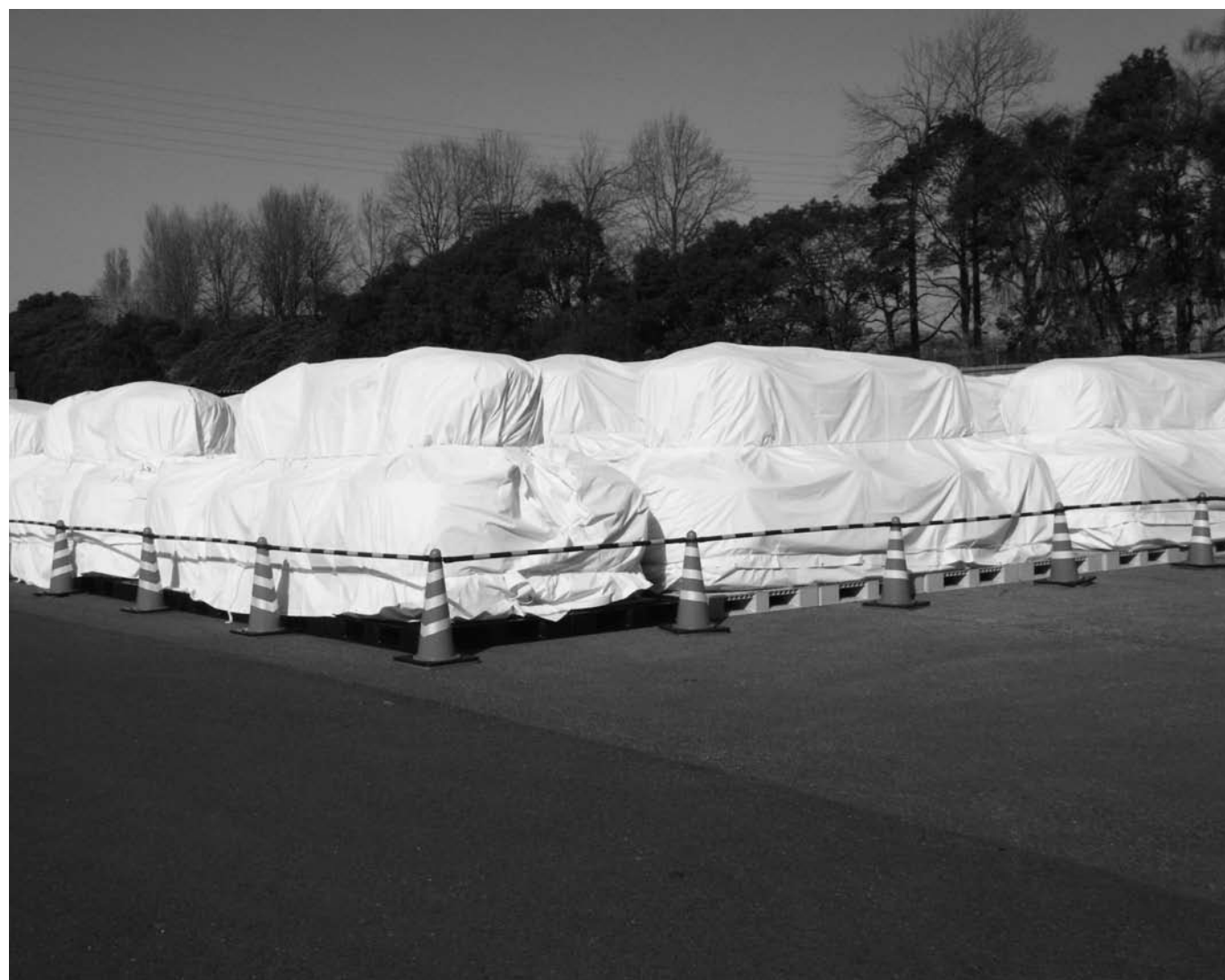
白いシートで覆った屋外の飛灰
