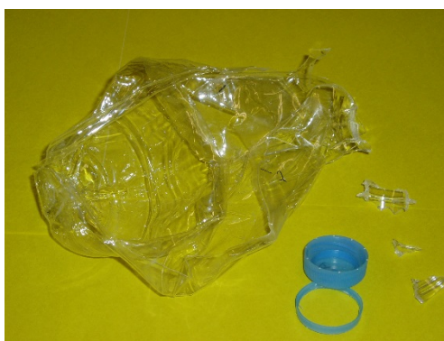
図 2 破裂後のペットボトルの外観 3
