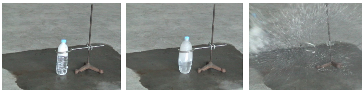
図 2 破裂後のペットボトルの外観 3
