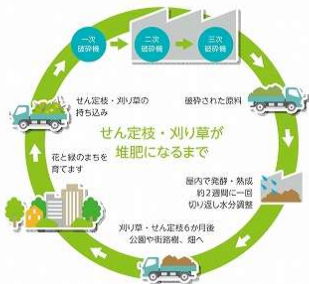
図3-6 東埼玉資源環境組合堆肥化施設
